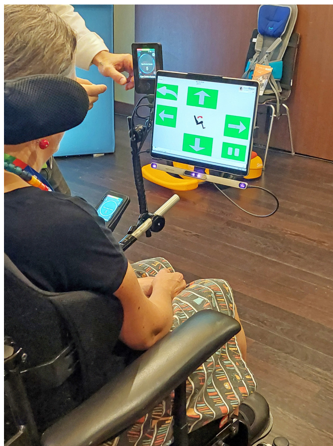
Obrázek 3 Elektrický vozík ovládaný zrakem
