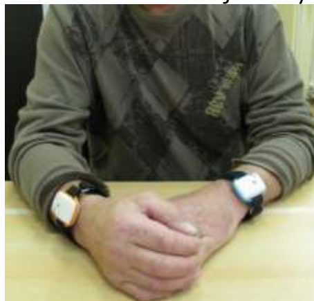
Obrázek č. 1 Umístění inerciální jednotky na zápěstí
